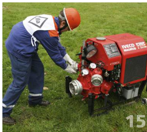
Er macht die Tragkraftspritze (TS) betriebsbereit
