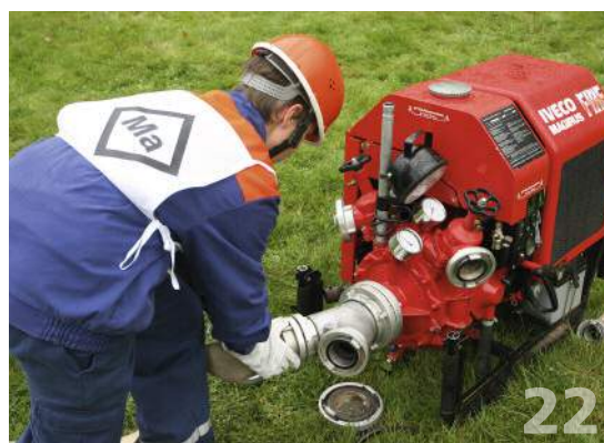
22 Der Maschinist kuppelt den B-Druckschlauch an die TS an.
