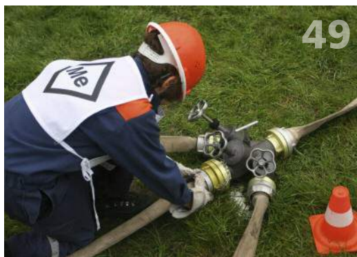
Der Melder übernimmt den Verteiler und die Kupplung des C-Druckschlauches vom Schlauchtrupp, kuppelt am Verteiler an und bedient ihn.
