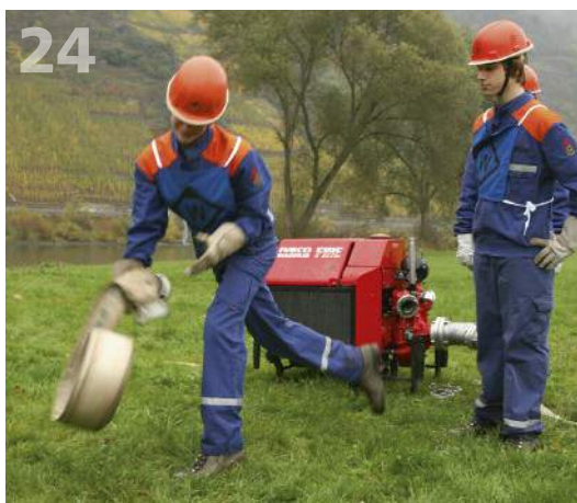
24 Nachdem die Wasserversorgung zum Unterflurhydranten hergestellt ist, verlegt der Wassertrupp den B-Druckschlauch ohne Schlauchverdrehung durch den Wassergraben bis zum Verteiler.
